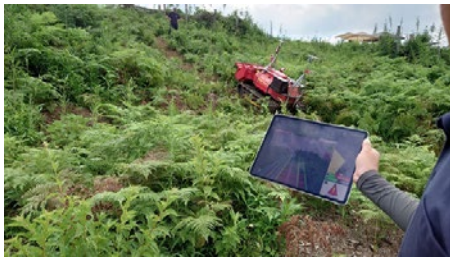
実証実験の様子(傾斜約25度を登坂している自動運転型下刈機械)
