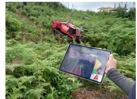
傾斜約25度を登坂する自動運転型下刈機械。最大傾斜45度まで走行・草刈が可能
